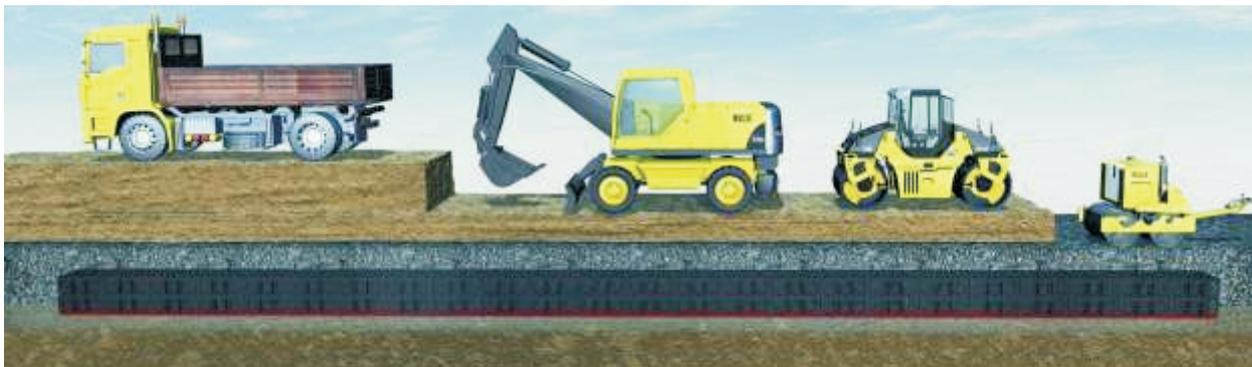
Различные строительные машины могут быть использованы для заполнения котлована. Учитывая дополнительные динамические нагрузки, которые вызывают работающие двигатели компрессорного и подобного оборудования, вызывающие дополнительную вибрацию, не следует использовать это оборудование над системой блоков.
