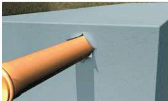
Вентиляционный стояк, также должен быть установлен в верхний ряд блоков, через отверстие в боковой стенке блока и поднят над уровнем грунта на 0,5м. Переход на вертикальное расположение трубы стояка выполнить с помощью колена на 90°
